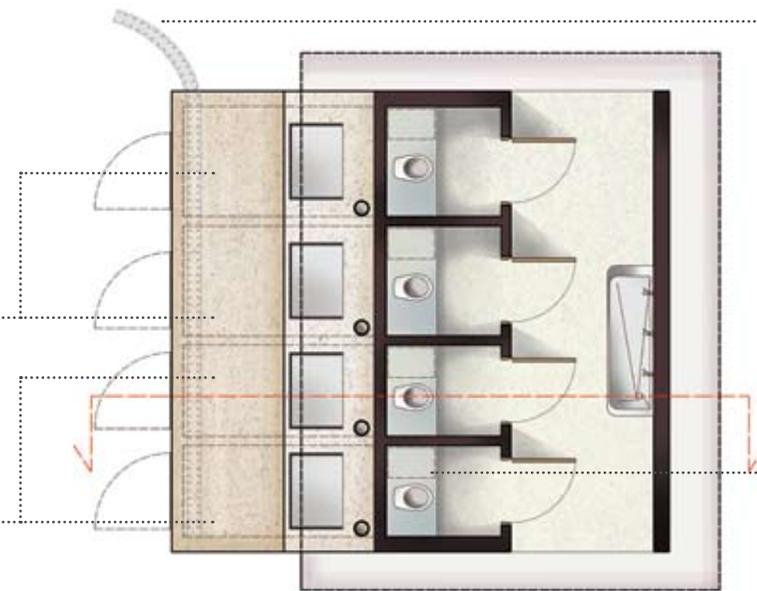
Tubo de drenagem para transportar fluido para o sistema de tratamento de águas residuais. Urina e outros líquidos saem da casa de banho de composto orgânico por um tubo de drenagem com um diâmetro de 10-16 perto do ponto mais baixo do sistema. Estes líquidos, em seguida, entram no sistema de tratamento de água à base de plantas
